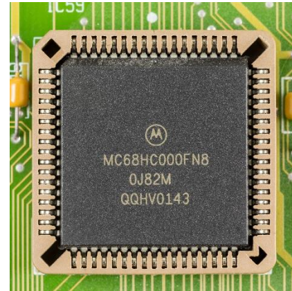
PROCESSORE 68000 MOTOROLA: esterno (sinistra) interno (destra)
